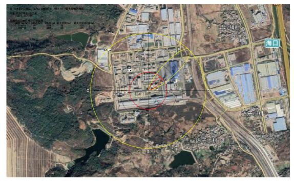
图 6.7-4 D 稳定度下超过阈值的最大影响区域图
