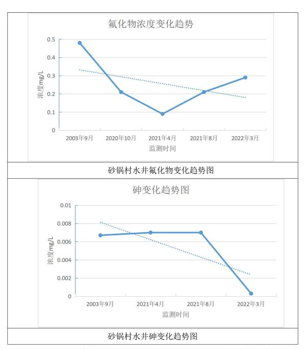
由表 4.6-6 沙锅村井对比情况看出,氟化物、总磷 2003 年初始值较高,2020年之后,基本维持稳定,趋势缓慢下降,砂锅村水井砷缓慢下降,2021年之后砷的监测值一直小于检出限。水质监测结果达到《地下水质量标准》(GB/T14848-2017)III类标准的要求。
