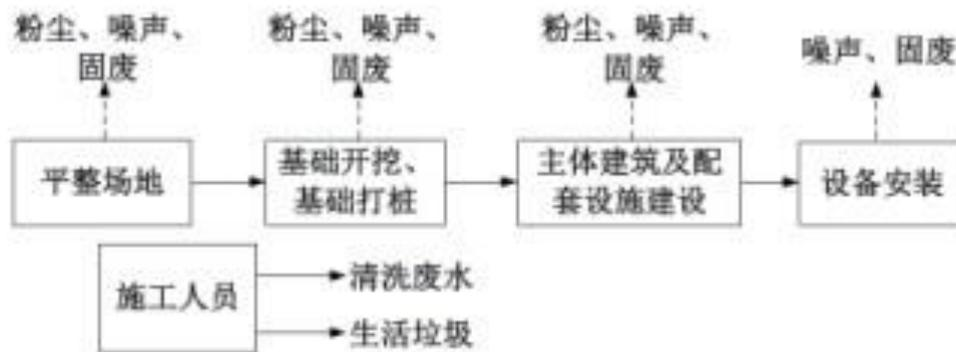
图 5-1 施工期工艺流程及产污位置图
